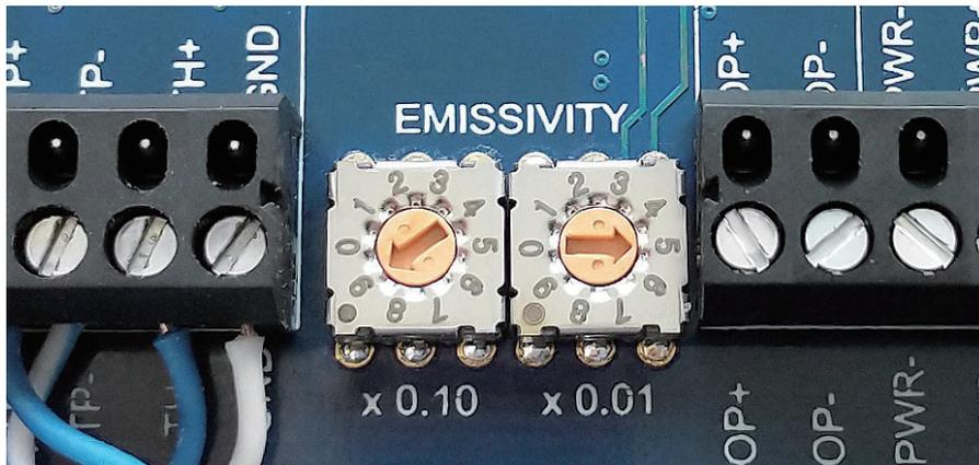
設定手順： 左のロータリスイッチで最初の小数点以下の最初の1桁 (0.6) を設定します。右のロータリスイッチで次の小数点2桁目の値 (0.01) の設定を行います。放射率 (emissivity) "1.00" の設定は、両方のロータリスイッチを "0" に設定ください。万一、設定値が下限以下の場合、自動的にデフォルト設定の放射率、"0.95" となります。
