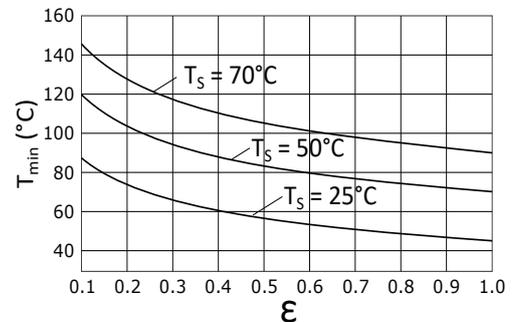
グラフは放射率とセンサヘッドの温度と最低測定可能温度の関係を示す
