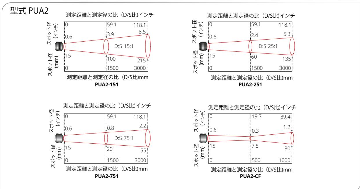
(記) 上図に示されている以上の距離からも測定しますが、スポットサイズは大きくなります。
