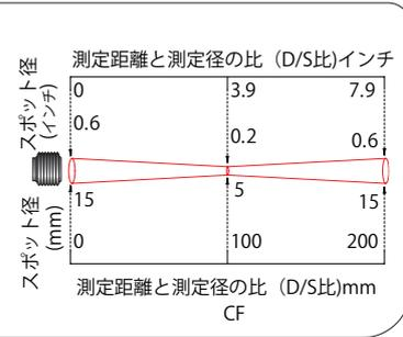
(記) 上図に示されている以上の距離からも測定しますが、スポットサイズは大きくなります。
