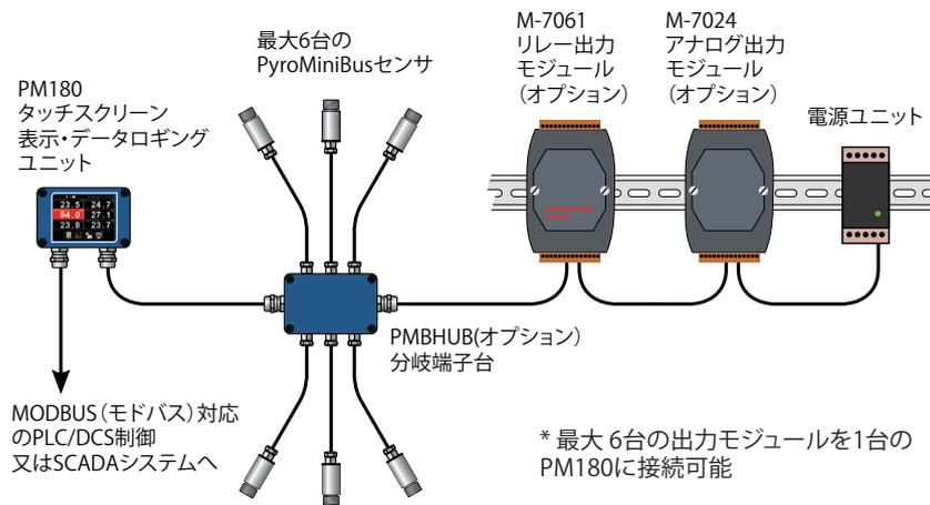
PyroMiniBus (パイロミニバス) は小型放射温度計センサとオプションの表示器で構成された工業用非接触放射温度計システムです。
