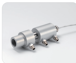
水冷空冷用ハウジング 型式 WJ 製品の型式記号の最後に接尾辞として付加 水冷空冷用ハウジングを使用しますと70℃を超える周囲温度雰囲気で使用できます。センサのレンズ表面の結露を防止するためにこのハウジングはエアパージカラと一緒に提供します。このハウジン
