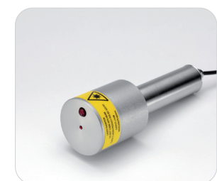
レーザ照準ツール 型式 LSTS: 測定対象を明確にするためにセンサの前部にネジ止めされます。一度、測定対象を特定した後、レーザ照準ツールは取り除くことができます。
